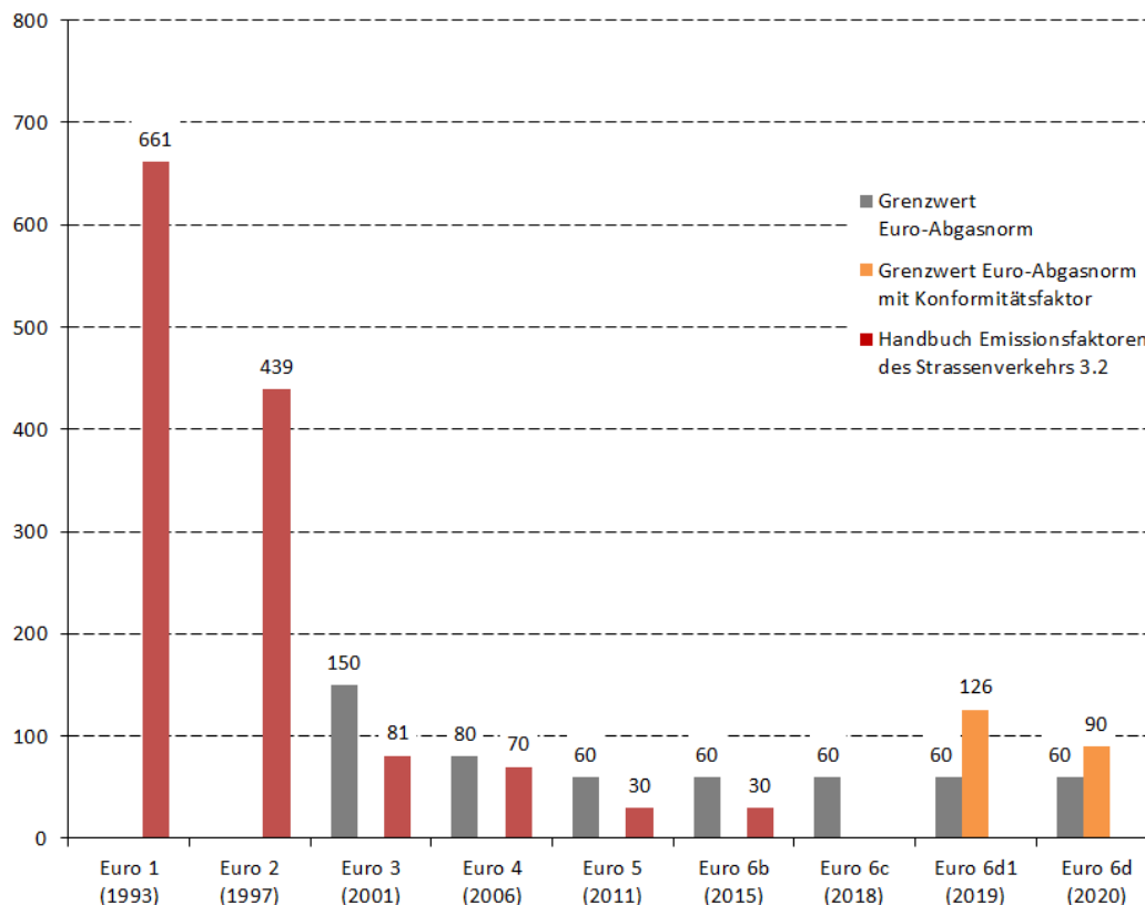
Abbildung 09 : NO x -Emissionsgrenzwerte der Euro-Abgasnormen und NO x -Emissionsfaktoren für eine durchschnittliche Innerortssituation in Deutschland 2015 für Benzin-Pkw in mg/km
