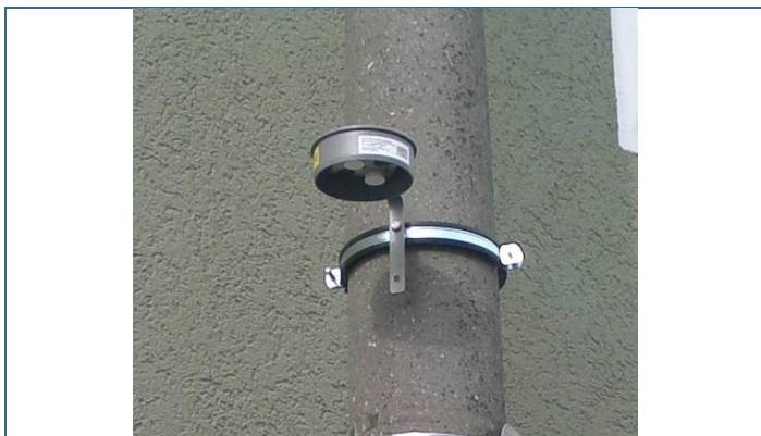
Abb. 9: Wetterschutzgehäuse mit Passivsammlern; die beiden Sammeleinheiten sind als weiße Plastikkapseln gut zu erkennen
