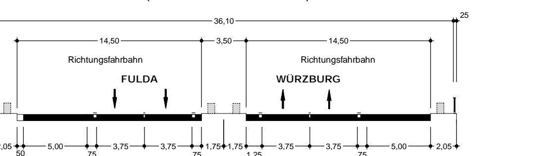
Regelquerschnitt außerhalb Bauwerksbereich (BW 657 a)
