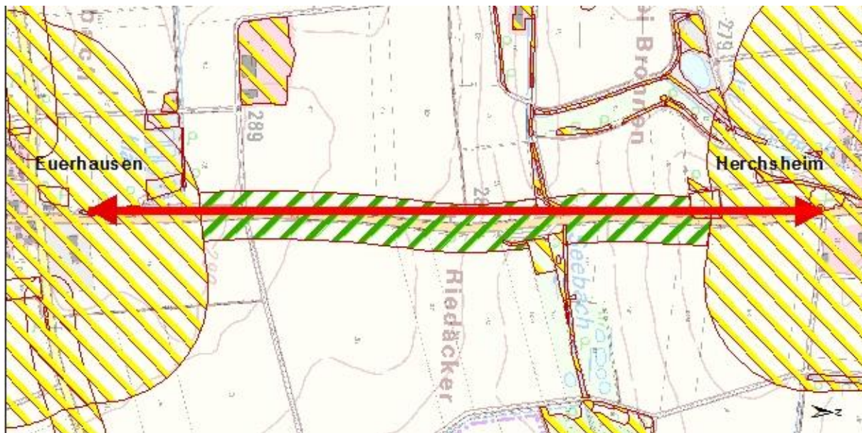
Abb. 2-4: Vorbelastung Zustand Rückbau. Grün schraffiert entlastete Bereiche
